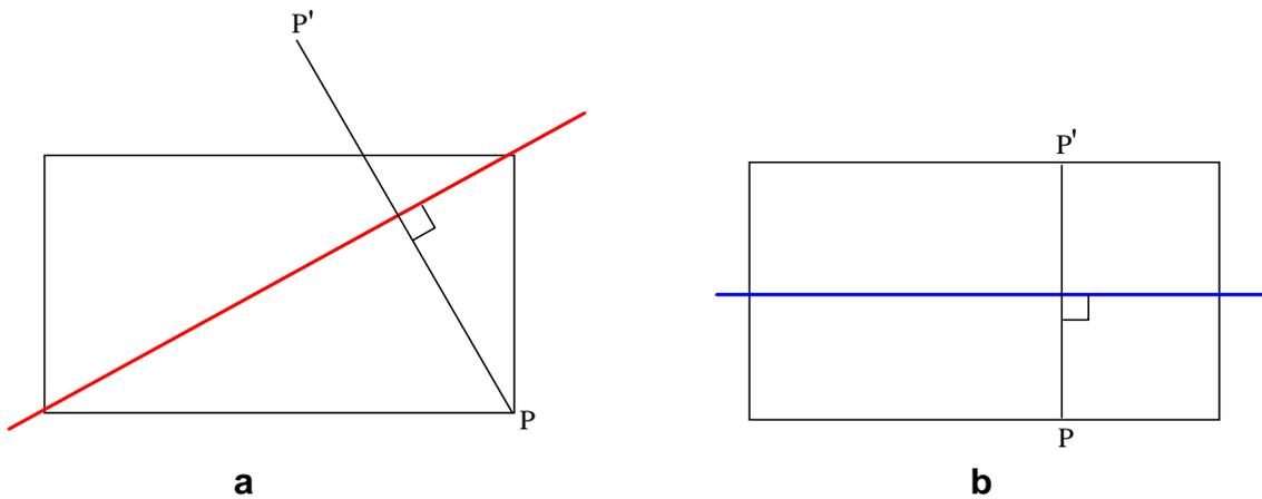
Figura 3 Repetição do ponto P através da perpendicular ao plano: a) pontos P e P' não são equivalentes, b) pontos P e P' são equivalentes.
