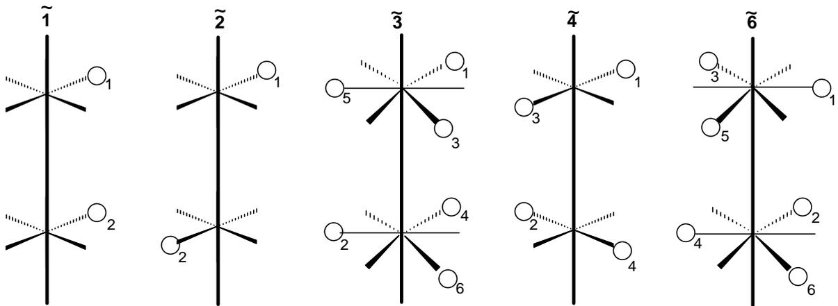
Figura 12. Eixos de rotoflexão.
